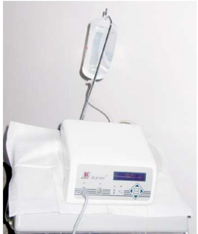
**FIGURA 7** - Motor cirúrgico com controle de torque.
